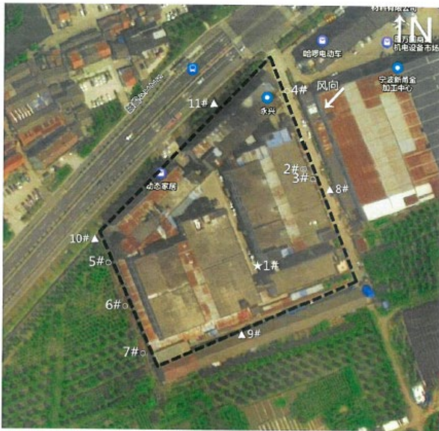
◎-有组织废气采样点; ○-无组织废气采样点; ★-废水采样点; ▲-工业企业厂界环境噪声检测点
